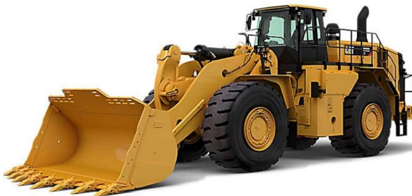
Foto 7 Caterpillar 988K XE, hybride loader
